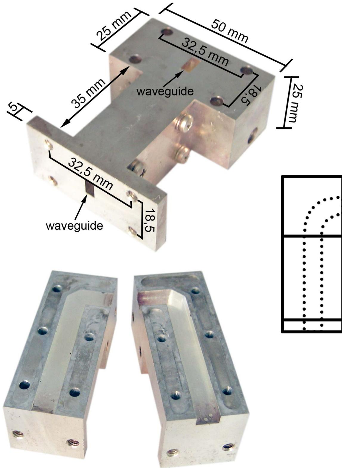
Guida d'onda tipo WR28 sulla banda di frequenza 26,5-40 GHz con curva a 90° sul piano H. Grazie alla sua forma si presta ad essere utilizzata anche come supporto. E' fatto di alluminio argentato diviso in due pezzi uniti da quattro viti, la costruzione è di notevole precisione.
