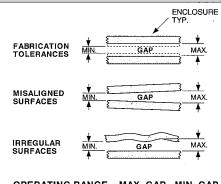
OPERATING RANGE = MAX. GAP - MIN. GAP NOMINAL COMPRESSION MAXIMUM COMPRESSION
