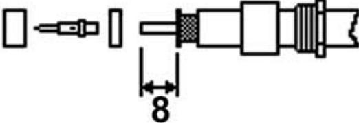
Rimuovere l'isolante per una lunghezza di 8 mm
